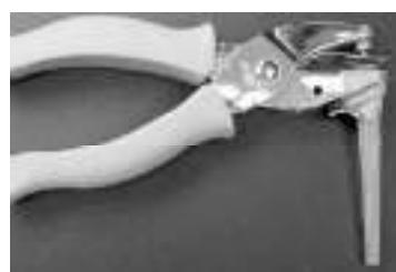
جهاز puncher المستخدم في قطع أقراص العينات من بطاقات FTA
